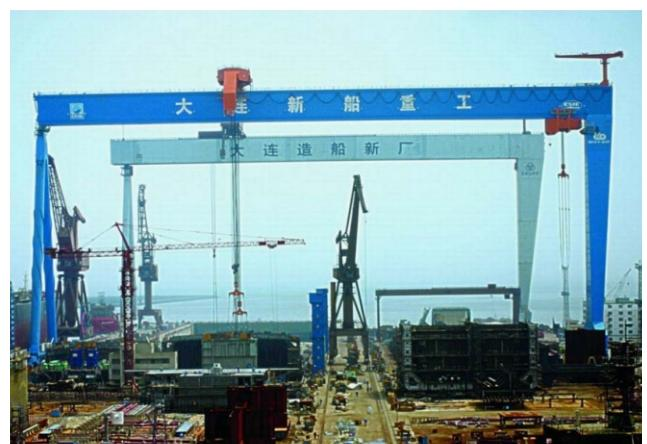
大连船舶重工600t 造船门式起重机
