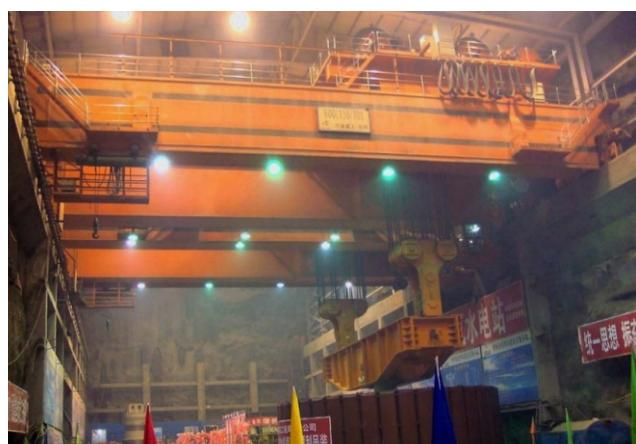
拉西瓦水电站800/150/15t 吊钩桥式起重机
